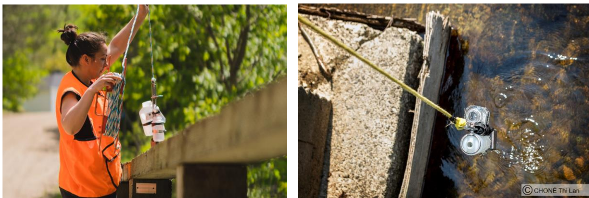
Figure 4 : Prélèvement d'échantillons à l'aide d'un porte-bouteille
