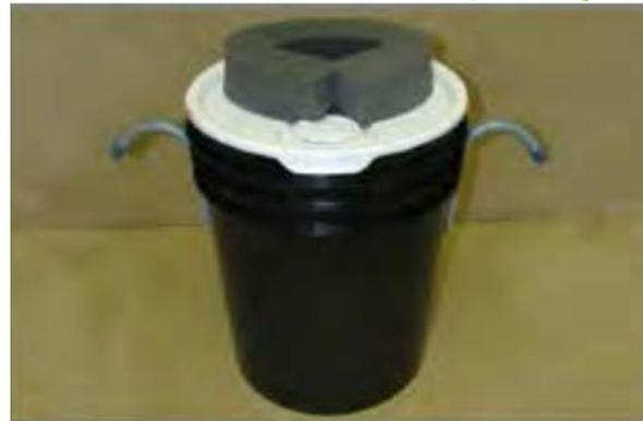
Figure 3 : Un aquascope est un appareil muni d'une lentille translucide (plexiglas) permettant d'observer le fond de l'eau sans l'effet réfléchissant de la lumière à la surface de l'eau. Photo : MDDELCC, 2016a
