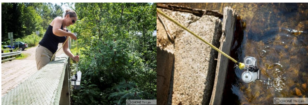
Figure 4 : Prélèvement d'échantillons à l'aide d'un porte-bouteille
